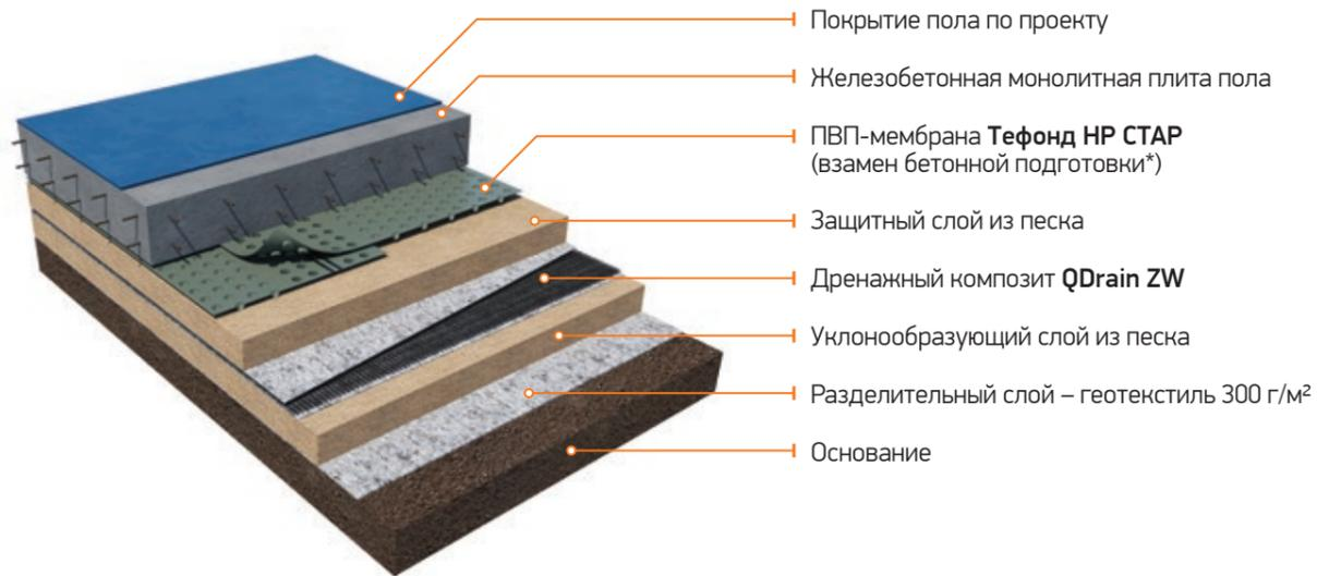
В данном решении при строительстве объектов большой площади применяют пластовый дренаж.
