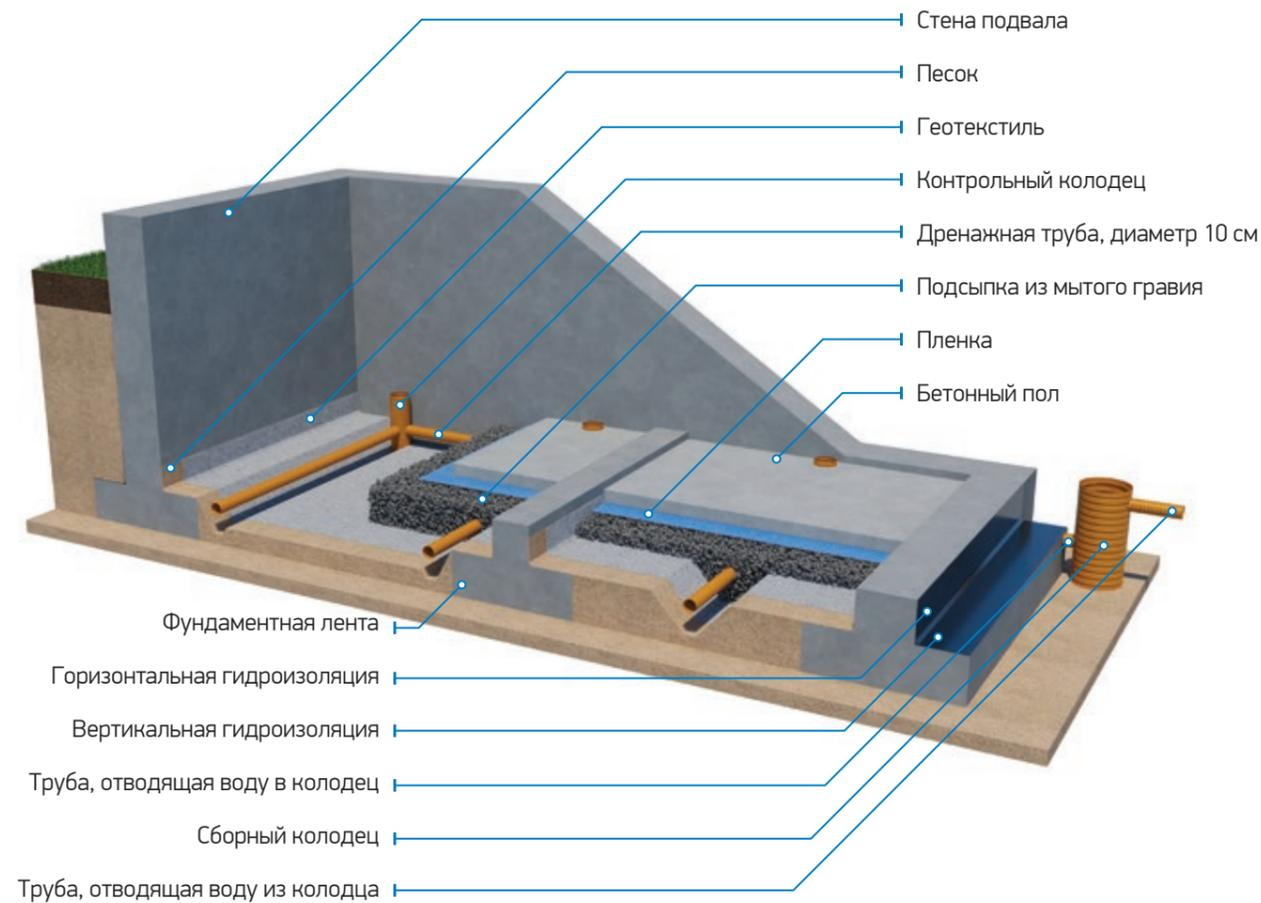
Классический пластовой дренаж представляет собой слой щебня или песка с высоким коэффициентом фильтрации, расположенный выше трубчатого дренажа. Слой укладывается по всей площади с таким расчетом, чтобы его края выступали за пределы защищаемого сооружения. Толщина пластового дренажа определяется расчетом условий местности и особенностей грунта в части его насыщения подземными водами. Пластовый дренаж должен непосредственно соприкасаться с трубчатым дренажем для беспрепятственного оттока воды.
