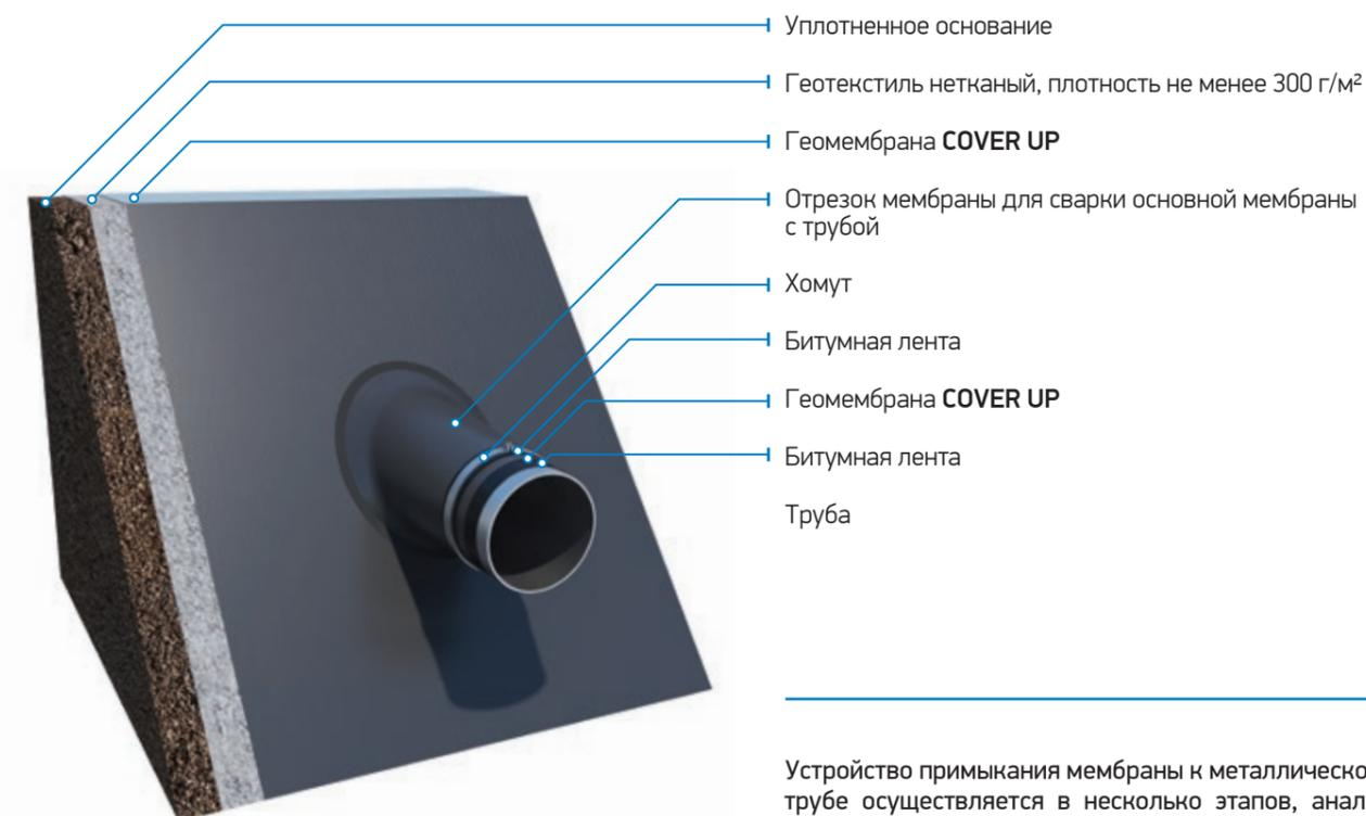
Устройство примыкания мембраны к металлической трубе осуществляется в несколько этапов, аналогичных примыканию к пластиковой трубе.
