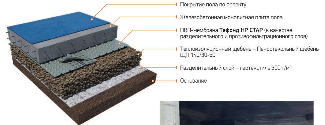
Профилированная мембрана **Тефонд НР СТАР** предотвращает утечку цементного молочка в слой пеностекольного щебня.
