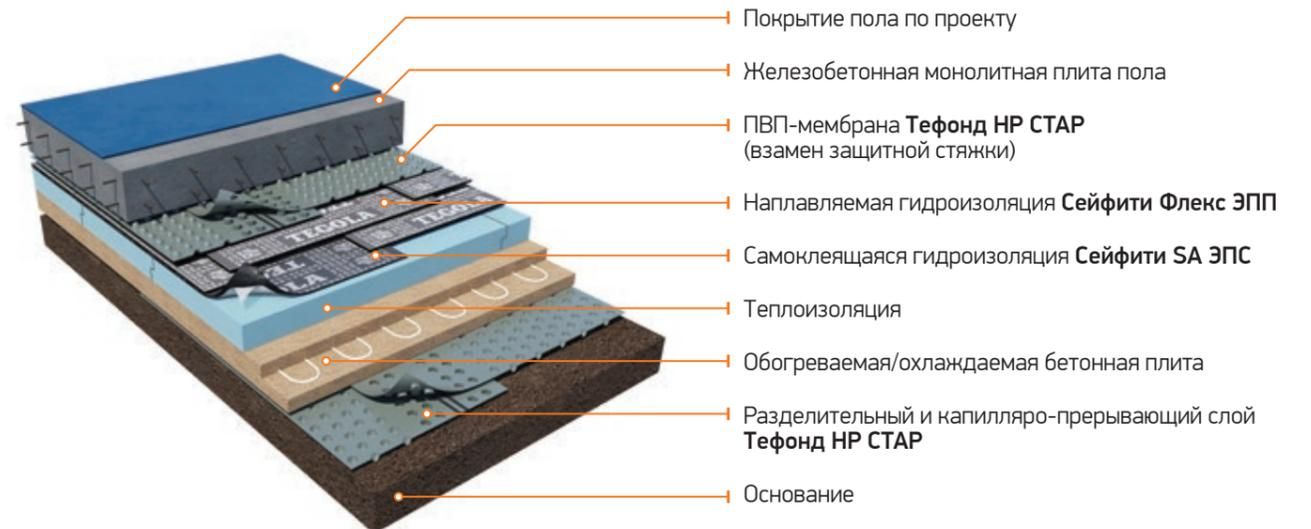
Решение может применяться при устройстве полов промышленных холодильников в условиях, где требуется дополнительный обогрев грунта.
