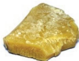
Полимер АПП, которым модифицирован материал, значительно улучшает долговечность битумных материалов и замедляет процесс их разрушения
