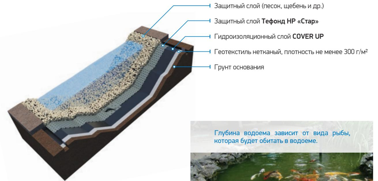
Высокая гибкость мембраны **COVER UP** обеспечивает удобство работы при строительстве водоемов для разведения рыбы, имеющих ряд особенностей:
