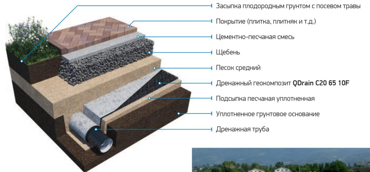
Устройство пластового дренажа с применением геокомпозита QDrain начинается с подготовки основания, его уплотнению и формировании проектного уклона. Далее укладываются рулоны дренажного геокомпозита.
