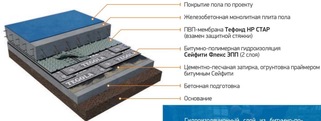
Гидроизоляционный слой из битумно-полимерного материала Сейфити выполняет роль противофильтрационного экрана, а также защиты конструкции пола от замачивания грунтовыми водами.
