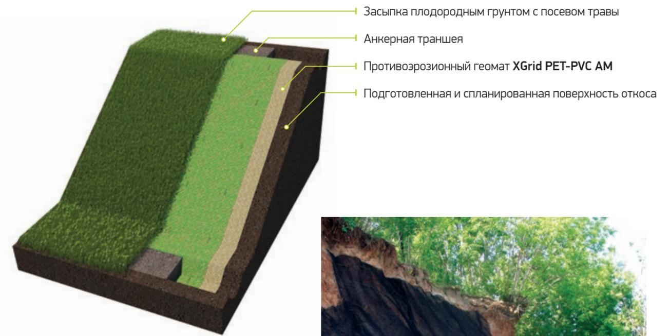
На крутых склонах возникает необходимость в повышенной прочности геомата на растяжение, т.к. сдвигающие силы грунта на этих склонах значительно выше, чем на пологих.
