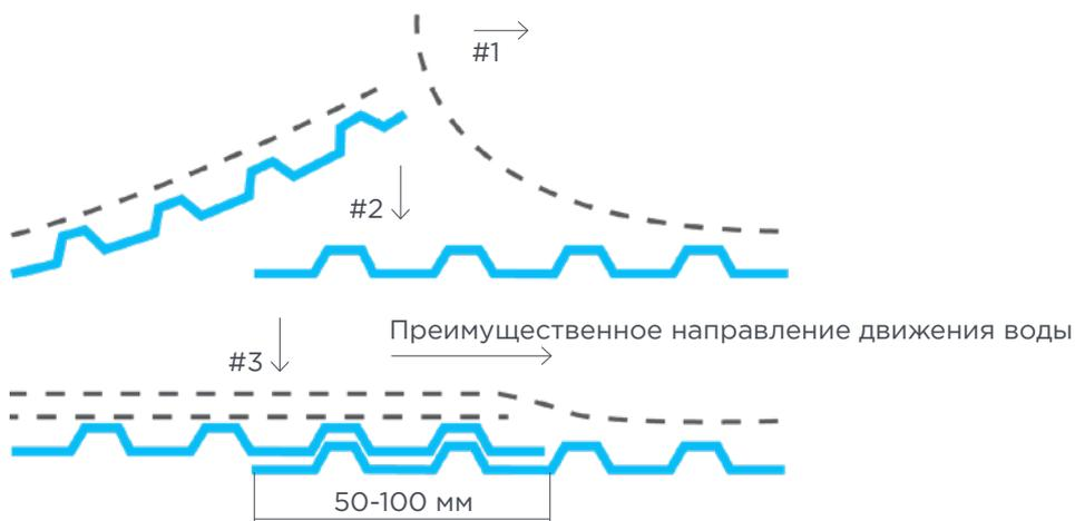
Сами поперечные и торцевые перехлесты выполняются в следующей последовательности: перед стыковкой полотен необходимо отогнуть полипропиленовое полотно от выступов с соответствующей стороны рулона на расстояние будущего нахлеста (#1). Далее выполнить нахлест полотнищ на 50-100 мм (#2). Отогнутое полотно отвернуть к мембране (#3) и зафиксировать стык вышележащими слоями благоустройства. Разбежка швов в смежных рядах должна составлять порядка 0,5 м.
