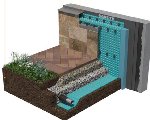
Данный **конструктив «мягкой» отмостки** можно рассматривать в контексте отсутствия необходимости в жестком основании и утеплении подстилающих грунтов. Также **по профилированной мембране TK-Net возможна отсыпка дренажных слоев из щебня** (песчано-гравийной смеси) с организацией в этом слое кольцевой трубчатой дрены.
