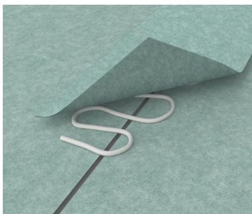
Между собой отрезки мембраны соединяются встык. После этого стык мембран дополнительно сверху герметизируйте лентой **TH2 Stop Tape**, приклеив ленту на **клей T-MS** по оси стыка.
