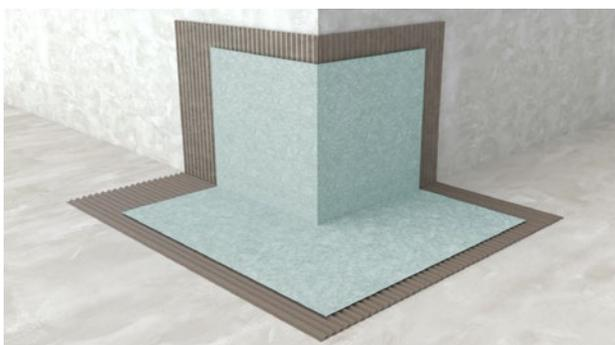
Приклейте угловые элементы по всем внутренним и внешним углам конструкции в соответствии с проектом.
