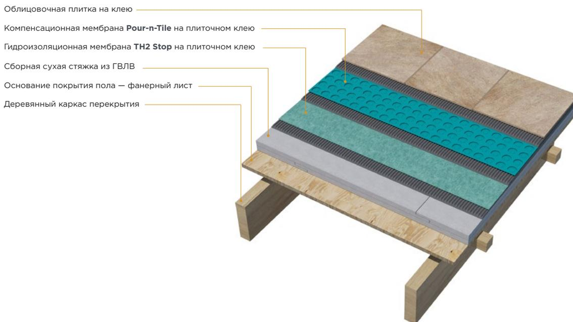
В конструкции открытых балконов или террас, как правило, **необходимо предусматривать основной гидроизоляционный слой для защиты элементов перекрытия** от воздействия атмосферной влаги.
