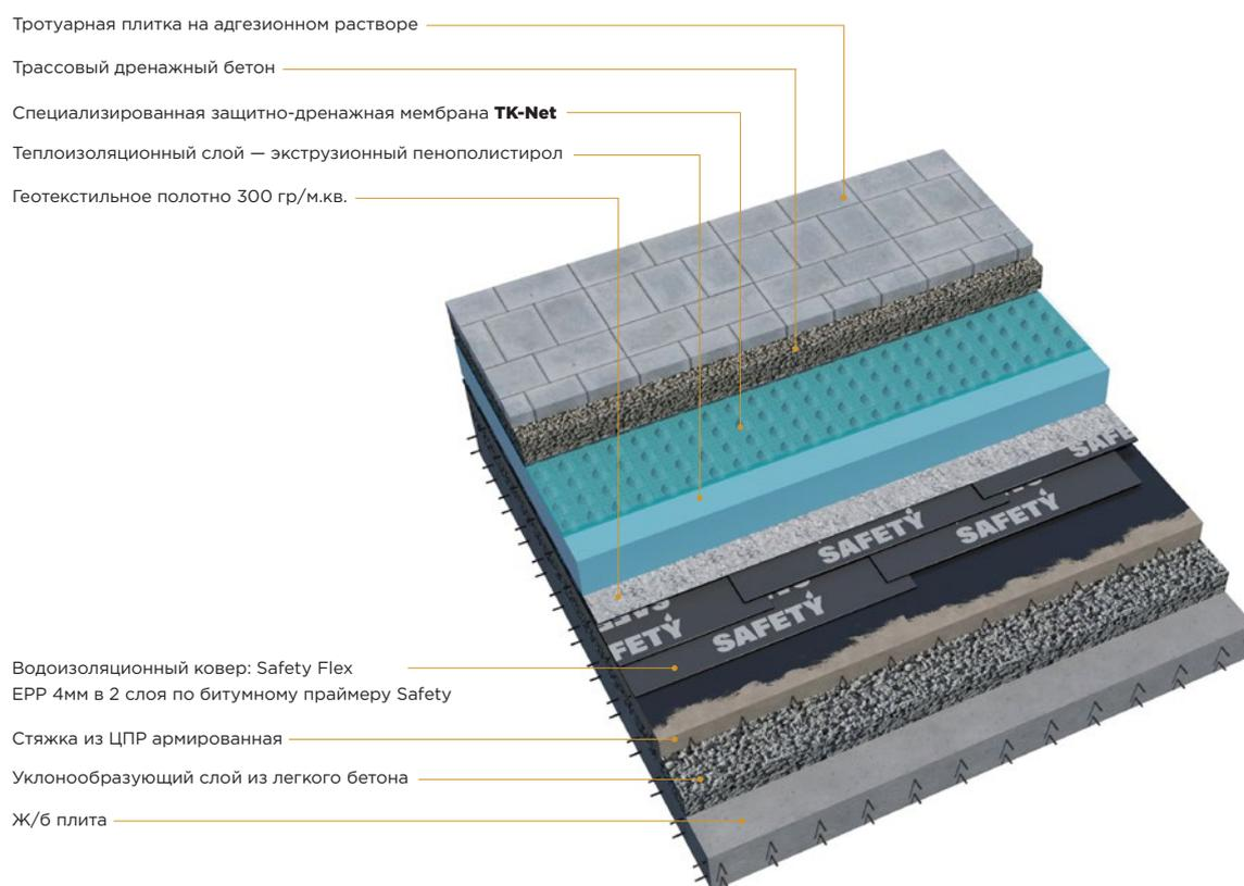
Наряду с традиционной системой кровли, описанной выше, существует инверсионная — **система изоляции, в которой слой теплоизоляции расположен над водоизоляционным слоем**. С целью улучшения теплотехнических характеристик такой конструкции и создания корректно работающего единого дренажного слоя рекомендуется применение **защитно-дренажной мембраны TK-Net**. Дополнительно мембрана защищает слой теплоизоляции от механического воздействия на время строительных работ и при дальнейшей эксплуатации.
