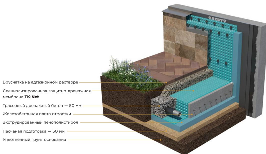
Мощение в конструкции отмостки зданий в настоящее время встречается достаточно часто и так же часто данная конструкция подвержена деформациям и нарушением своей основной функции — **защиты фундамента и цоколя от дождевой и талой воды**. Представленная конструкция может считаться высоконадежным решением с неоспоримыми преимуществами:
