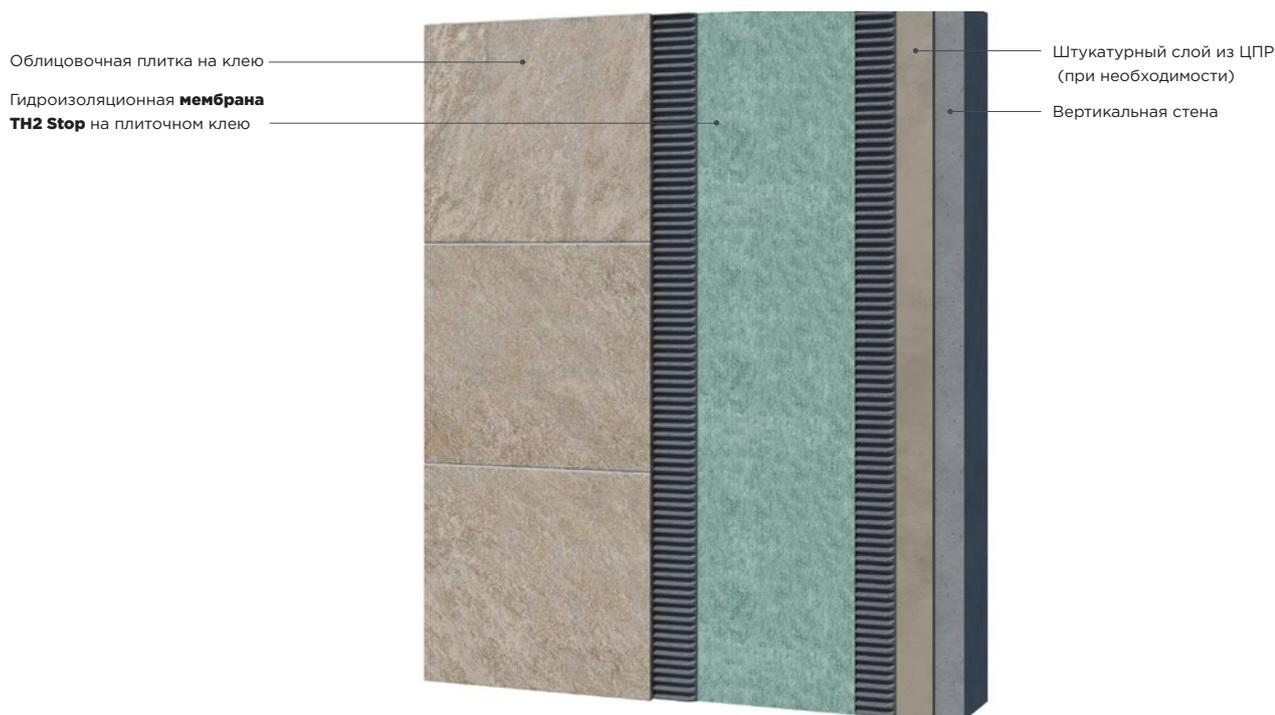
**Базовое решение устройства гидроизоляции вертикальных стен при попадании струи воды на поверхность.** Стены могут быть выполнены из самых разных материалов — кирпич, газо- и пеноблоки, силикатные блоки, монолитные бетонные конструкции и т.д. Каким бы ни был материал стен, его необходимо защищать по всей поверхности предполагаемого воздействия влаги в жидком состоянии.
