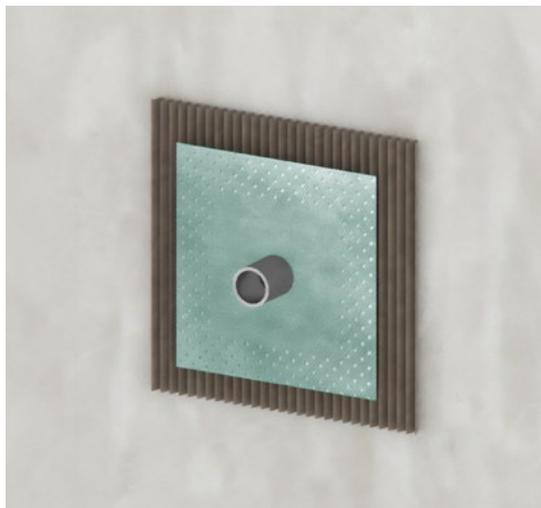
В местах выхода труб, закладных деталей и прочих коммуникаций из стен **необходимо установить на основание манжету TH2 Stop Wall Collar**. Отверстие в манжете предварительно вырезается под требуемый диаметр (контур) примыкающей трубы. Как и прочие элементы системы манжета приклеивается к основанию на плиточный клей. При необходимости периметр примыкания **можно обработать клеем T-MS**.
