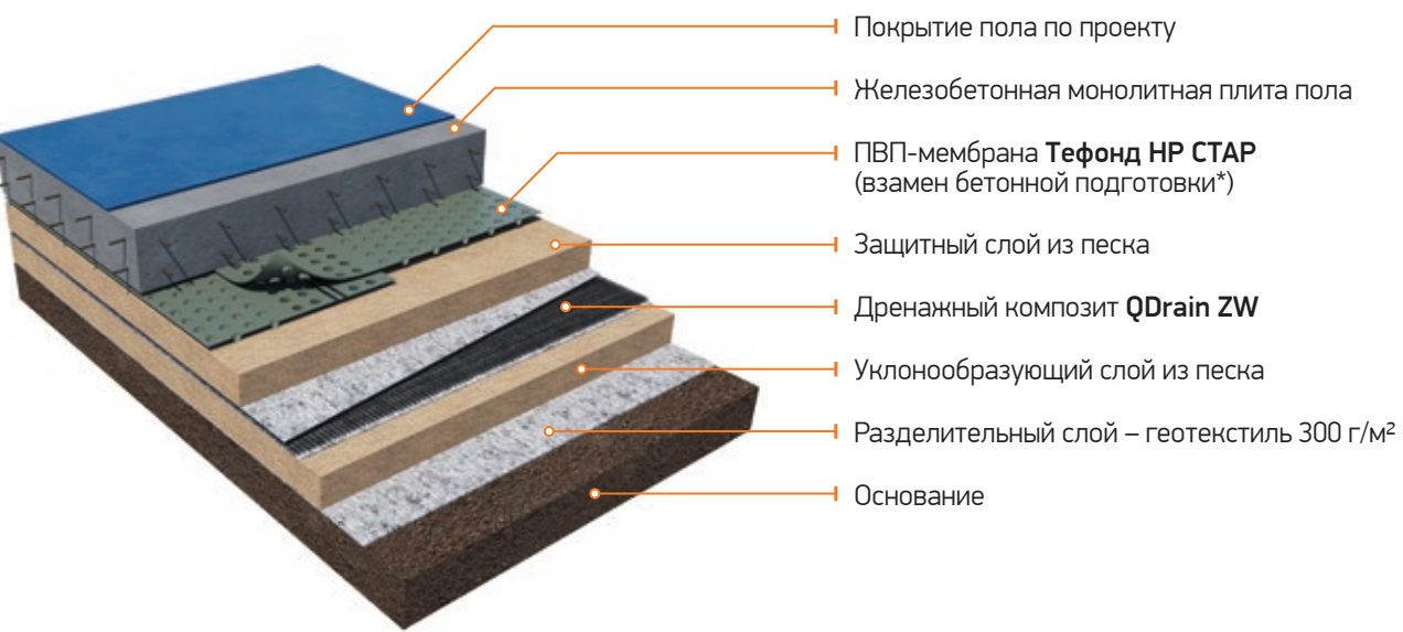
Профилированная мембрана Тэфонд HP СТАР позволит уйти от устройства бетонной подготовки*, сэкономить на строительных материалах и сроках строительства
