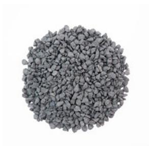
**Посыпка крупнозернистая базальтовая** — используется в качестве верхнего защитного слоя с применением Мастики кровельной горячей TEGOLA для латочного ремонта поврежденных кровельного ковра и для восстановления внешнего вида в местах локального перегрева наплавленного материала.
