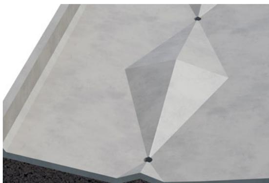
Для устройства уклонообразующего слоя применяют засыпные материалы (пеностекольный щебень, керамзитовый гравий и другие), легкие бетонные смеси (керамзитобетон, полистиролбетон, пенобетон и т.п.), цементно-песчаные составы и клиновидные плиты теплоизоляции.
