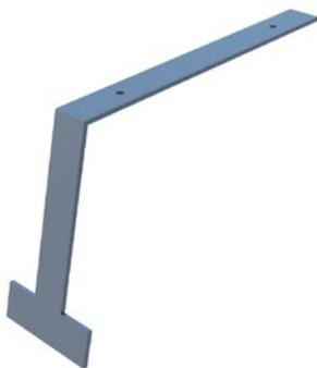
Металлический костыль толщиной не менее 4 мм, на который будет крепиться свес из оцинкованной стали. Костыль должен быть обработан антикоррозионным составом.
