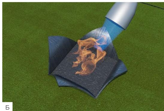
Просушите основание под кровлю, прогревая его пламенем горелки.
