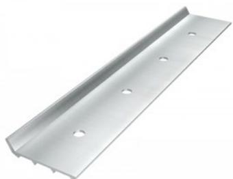
**Рейка краевая (с увеличенным краевым отгибом с верхней стороны)** — используется для закрепления края кровельного ковра на вертикальной поверхности. в отгиб краевой рейки закладывают герметик для защиты от затекания воды с вертикальной поверхности за кровлю.
