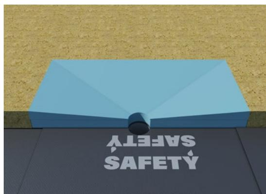
Выполните местное понижение у воронки путем замены в данном участке утеплителя на более эффективный теплоизоляционный материал. Например, заменив минераловатный утеплитель на ЭППС или PIR.
