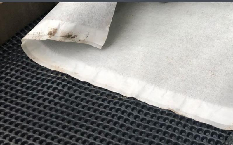
**Важно!** Укладку Maxistud F и QDrain ZW производите при температуре от -15 °С до +40 °С.
