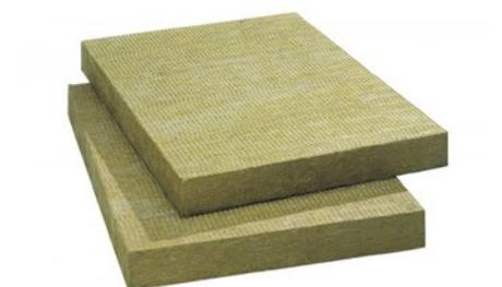
**Минеральная вата (MW)** — представляет собой плиты из стеклянных или базальтовых (каменных) волокон. При контакте с водой требует замены, т.к. насыщается ею существенно увеличивая теплопроводность. Группа горючести НГ.
