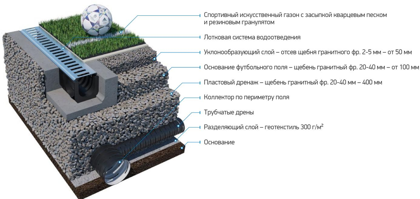
Как правило, используется **щебень твердых пород** разных фракций. В основании размещается система горизонтальных трубчатых дрен (перфорированных труб), направляющих воду в коллекторную систему по периметру спортивной площадки и далее в канализационную систему.
