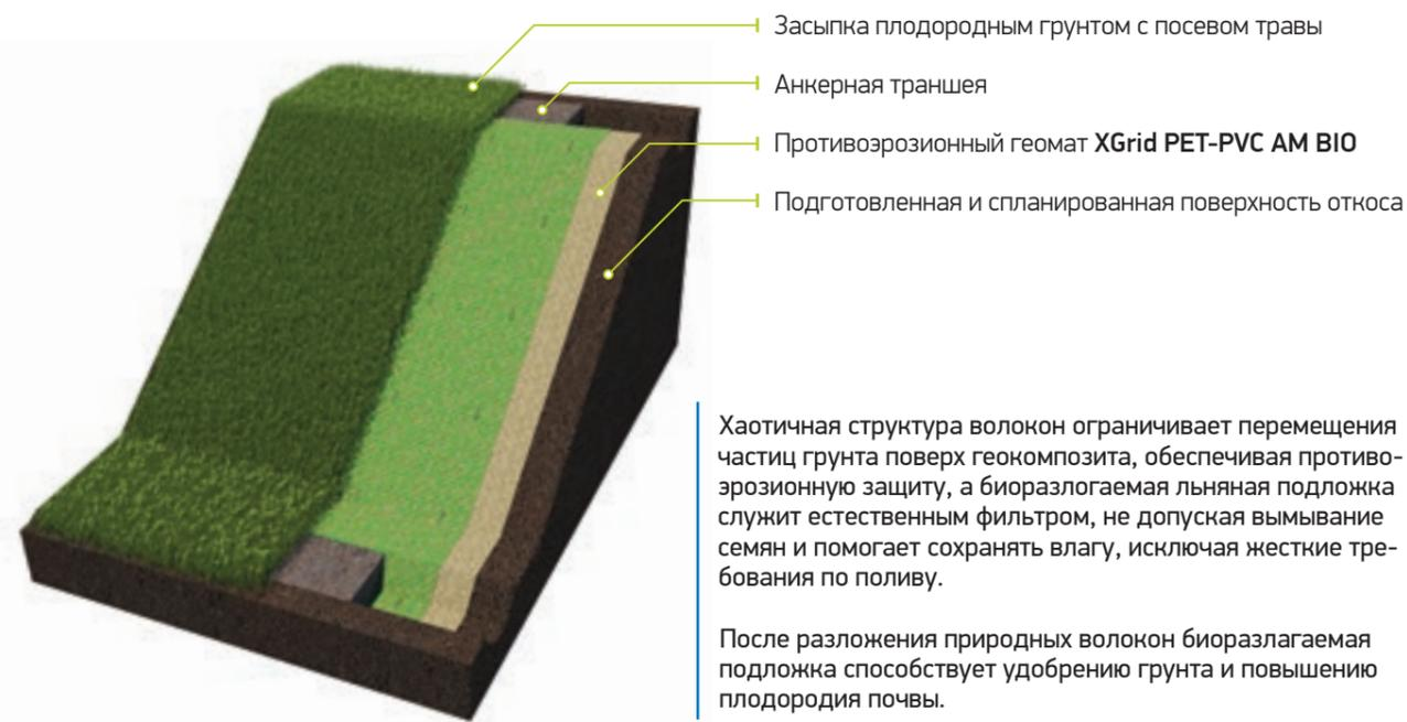
Хаотичная структура волокон ограничивает перемещения частиц грунта поверх геокомпозита, обеспечивая противоэрозионную защиту, а биоразлагаемая льняная подложка служит естественным фильтром, не допуская вымывание семян и помогает сохранять влагу, исключая жесткие требования по поливу.
