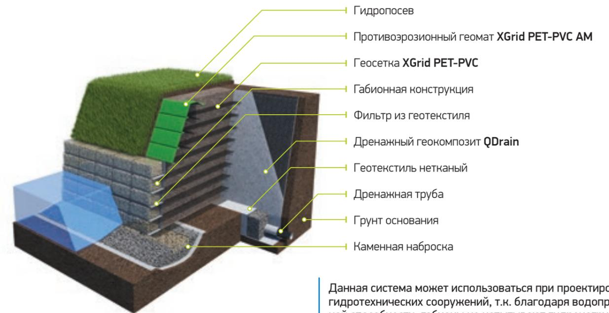
Данная система может использоваться при проектировании гидротехнических сооружений, т.к. благодаря водопропускной способности, габионы не испытывают гидронагрузки.
