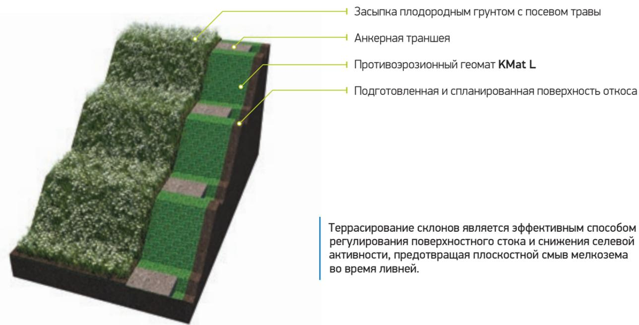
Террасирование склонов является эффективным способом регулирования поверхностного стока и снижения селевой активности, предотвращая плоскостной смыв мелкозема во время ливней.
