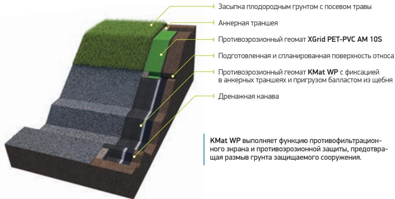
KMat WP выполняет функцию противодиффузионного экрана и противозерозионной защиты, предотвращая размыв грунта защищаемого сооружения.
