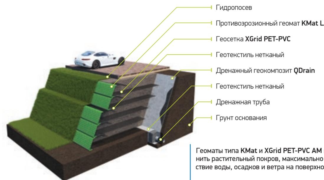
Геоматы типа KMat и XGrid PET-PVC AM позволяют сохранить растительный покров, максимально сокращая воздействие воды, осадков и ветра на поверхность откоса.
