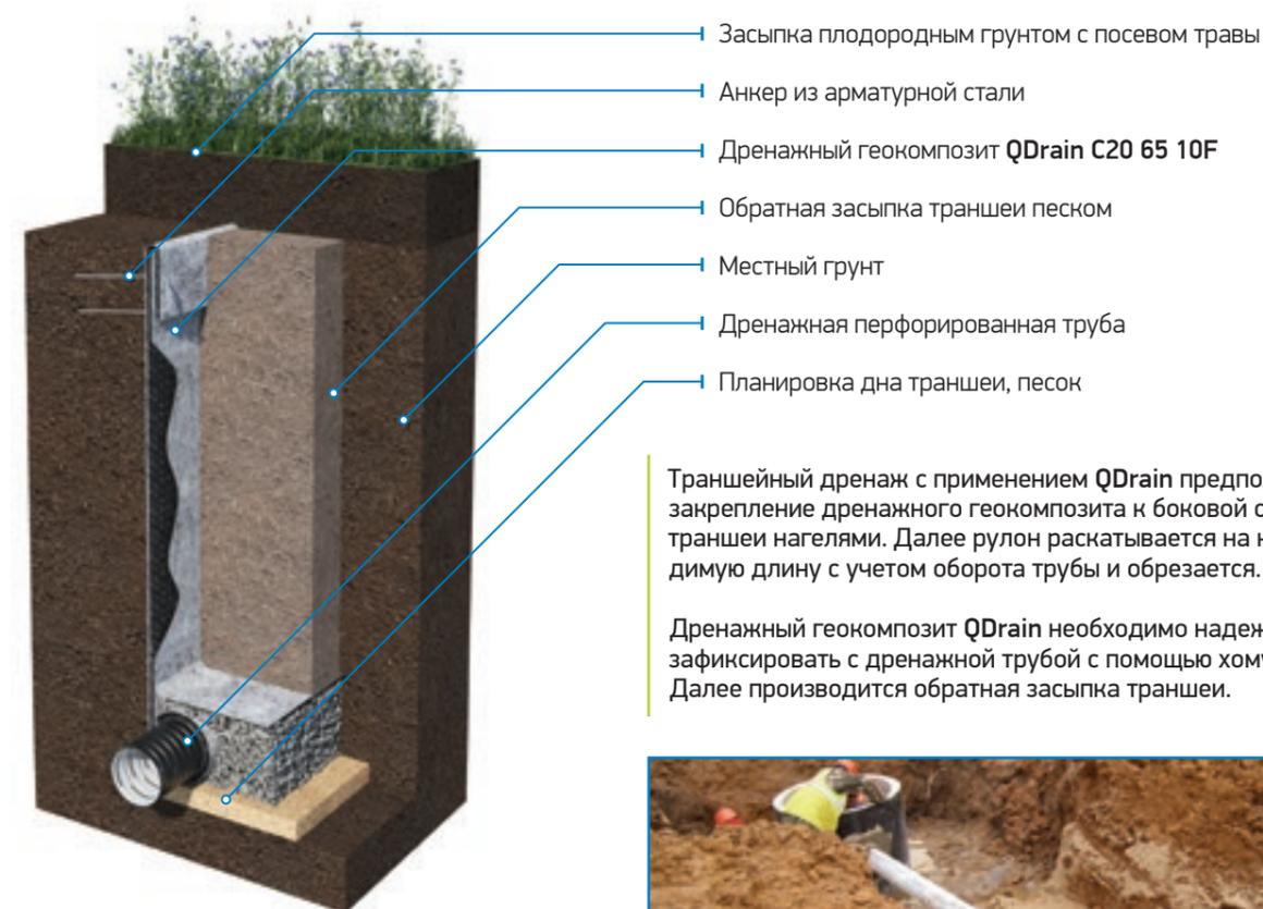
Траншейный дренаж с применением QDrain предполагает закрепление дренажного геокомпозита к боковой стенке траншеи нагелями. Далее рулон раскатывается на необходимую длину с учетом оборота трубы и обрезается.
