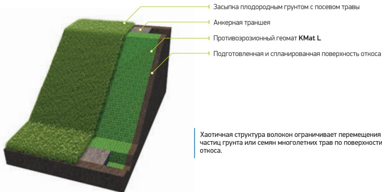
Хаотичная структура волокон ограничивает перемещения частиц грунта или семян многолетних трав по поверхности откоса.
