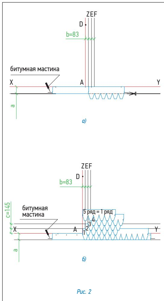
Для монтажа кровельного покрытия необходимо ровное, сухое и чистое основание, которое может быть выполнено из ОСП (ориентировано-стружечной плиты), фанеры повышенной влагостойкости, шпунтованной, обрезной доски, железобетонных плит и т.д. Стыки элементов основания следует располагать вразбежку с зазором 3–4 мм, при этом перепады по высоте не должны превышать 2 мм.
