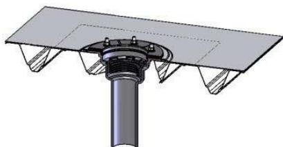
Вставить уплотнительное кольцо от обратного подпора в кровельную воронку таким образом, чтобы верхняя выступающая кромка (между упорами) легла на выступ чаши. Предварительно нанести смазочное средство на внутреннюю часть уплотнительного кольца и наружную часть трубы надставного элемента.
