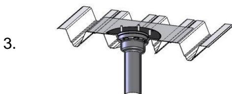
Уложить большой уплотнительный манжет через шпильки на жесткий фланец SitaMulti. При использовании битумных гидроизоляционных материалов, резиновые уплотнительные манжеты не требуются, просто смазать жёсткий фланец парашютной воронки битумным праймером и приварить к нему битумный гидроизоляционный материал.
