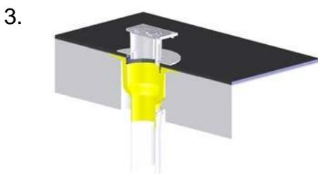
Установить Sita террасную насадку на кровельную воронку или надставной элемент. Высота террасной насадки выставляется при помощи регулировочного кольца, а так же перестановкой корпуса насадки в этом кольце. Свободная установка террасной насадки позволяет воспринимать динамические нагрузки от всех конструктивных слоев кровли.
