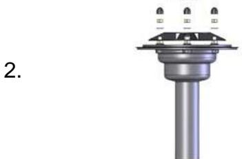
Надеть на шпильки подкладочные шайбы и шестигранные гайки, затянуть вручную. Надеть защитные колпачки на гайки.
